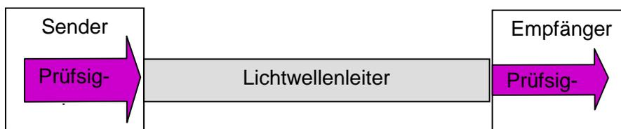
**Abbildung 2-1: Prinzip Dämpfungsmessung**
