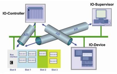
Pucyнok 5.1: В PROFINET IO несколько контроллеров могут иметь доступ к одному и тому же устройству.
