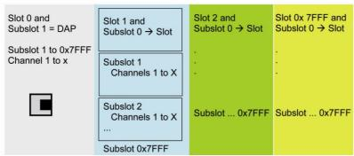
Рисунок 2.2: Данные ввода/вывода в PROFINET адресуются с помощью слотов и подслотов.
