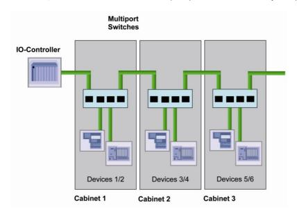
Рисунок 10.1: Звездная и линейная топологии могут комбинироваться в системах соединения Ethernet/PROFINET.
