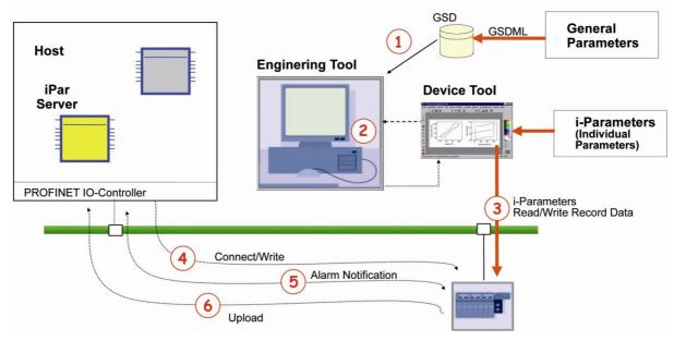
Рисунок 7.3: iPar сервер позволяет автоматически восстанавливать данные из резервной копии, когда устройство заменяется.
