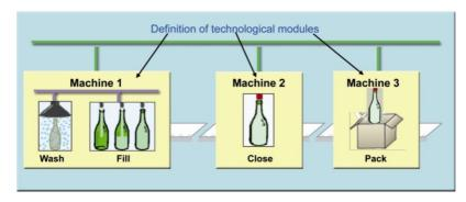
Рисунок 15.3: В PROFINET отдельные узлы могут быть комбинированы в один технологический модуль.
