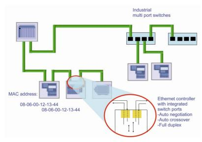
Рисунок 2.1: Полевые устройства PROFINET IO всегда соединяются через коммутаторы.
