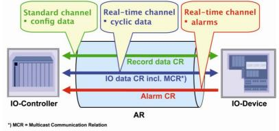
Рисунок 5.2: Обмен данными в PROFINET IO инкапсулирован в Прикладных и Коммникационных Отношениях.
