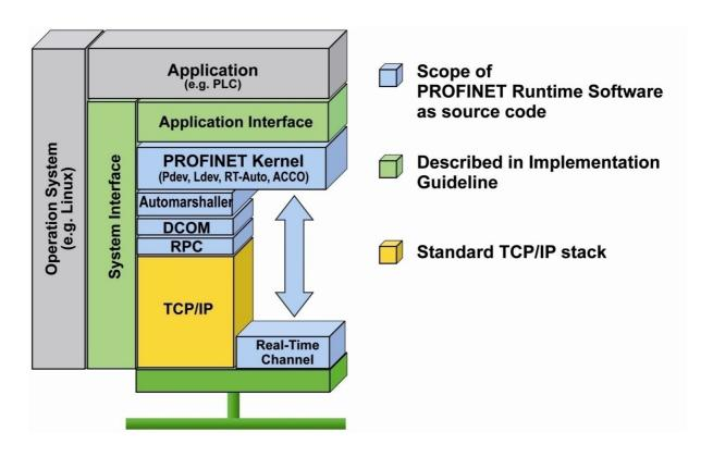
Рисунок 15.8: Стэк ПО для компонентной модели доступен в исходных кодах.
