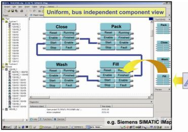
Рисунок 15.5: В PROFINET коммуникации конфигурируются, а не программируются. Здесь: пример использования iMap om Siemens.
