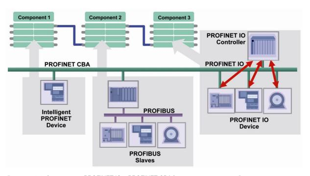
Pucyнoк 15.7: Совмещение PROFINET IO и PROFINET CBA дает максимальную гибкость в конфигурировании промышленного объекта.
