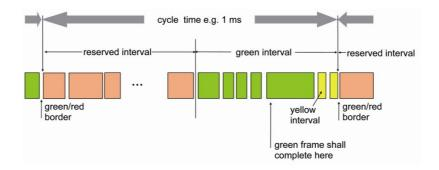
Рисунок 6.2: IRT связь делит цикл обмена на резервную фазу и открытую фазу.
