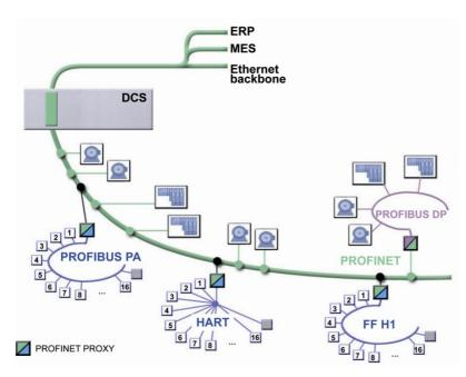
Рисунок 13.1: Пример архитектуры для использования PROFINET в автоматизации процессов.
