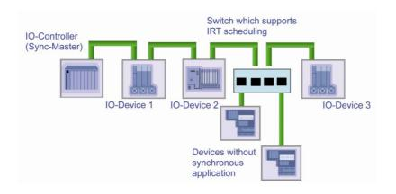
Рисунок 6.5: Смешанная работа синхронных и асинхронных задач.
