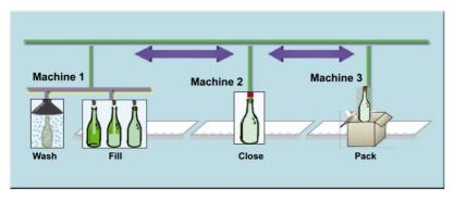
Рисунок 15.1: Пример управляющей последовательности на производстве.
