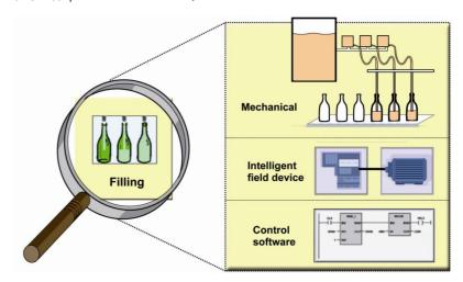
Рисунок 15.2: Технологический модуль состоит из механического, элетронного и программного обеспечения.
