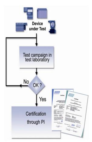
Рисунок 20.2: Последовательность сертификации PROFINET.
