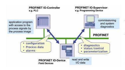
Рисунок 1.3: Хорошая структуризация каналов связи в PROFINET IO
