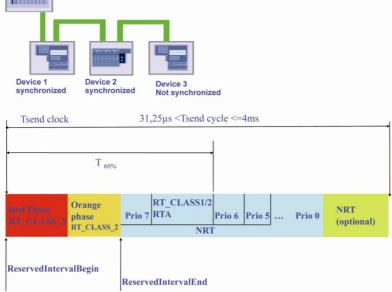
Рисунок 6.4: PROFINET IO контролирует точный порядок следования данных внутри цикла отправки.
