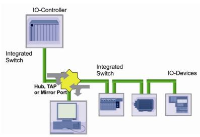
Рисунок 20.1: Тестирующее подключение для сбора Ethernet фреймов.
