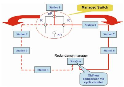
Рисунок 10.4: Резервирование средств связи для RT фреймов включает в себя безударную перекоммутацию каналов связи в случае отказа.
