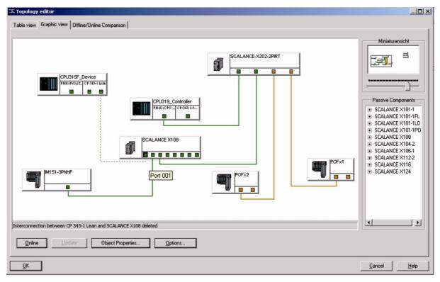
Рисунок 5.5: Визуализация топологии промышленного объекта дает возможность быстрого осмотра структуры и состояния оборудования
