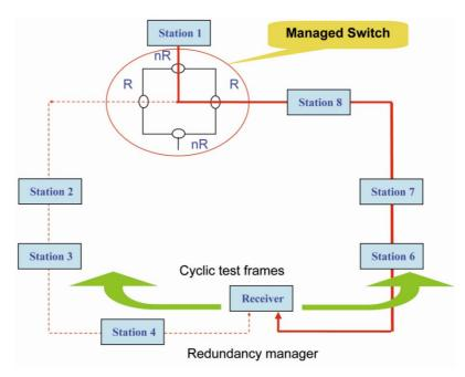
Рисунок 10.3: Резервирование средств связи с протоколом МRP повышает работоспособность промышленного объекта.
