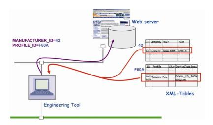
Рисунок 8.1: Принцип работы I&M функций.
