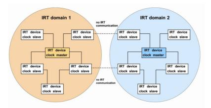
Рисунок 6.3: Каждый IRT домен использует свой собственный генератор тактов для синхронизации vзлов.
