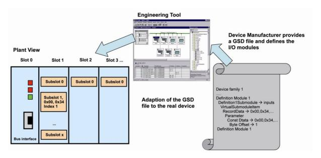
Рисунок 4.1: Опеределения из GSD файла назначаются IO-устройствам во время конфигцурации промышленного объекта.
